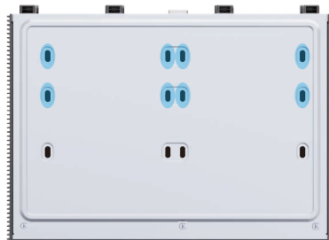
Pentru instalarea hard diskului de 3,5 inci
